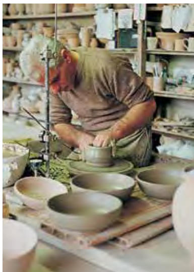
Le forme circolari vengono modellate direttamente al tornio
